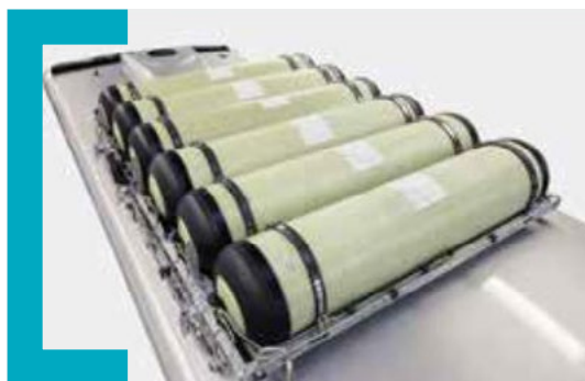
Fixation des réservoirs GNV sur le toit des véhicules
