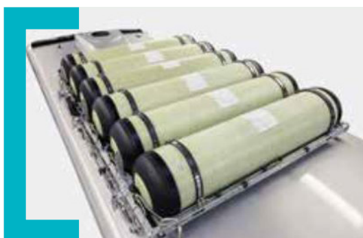
Fixation des réservoirs GNV sur le toit des véhicules
