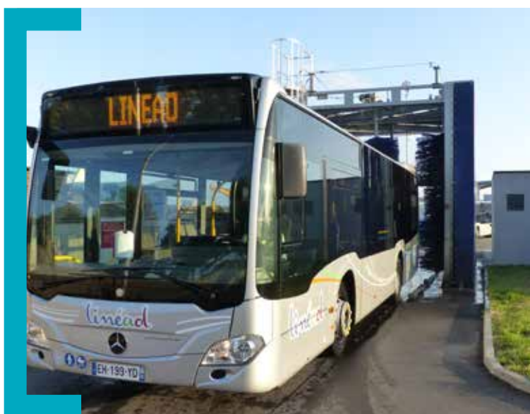
Lavage bus portique
