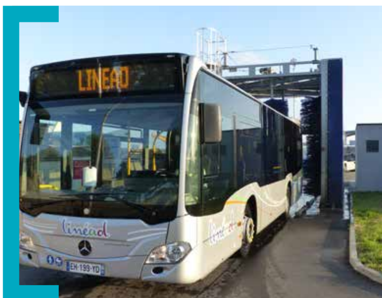
Lavage bus portique
